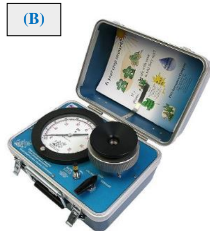
Figura 12. Medición del \Psi : (A) Cámara de presión en laboratorio de la Universidad de La Rioja. (B) Cámara de Schölander portátil que necesita de una bomba externa de aire comprimido para su funcionamiento. Fuente: (A) Rafael Tomás Las Heras. (2019). Práctica 6. Determinación del estado hídrico de la vid. Universidad de La Rioja. (B) https://coltein.com/ .
