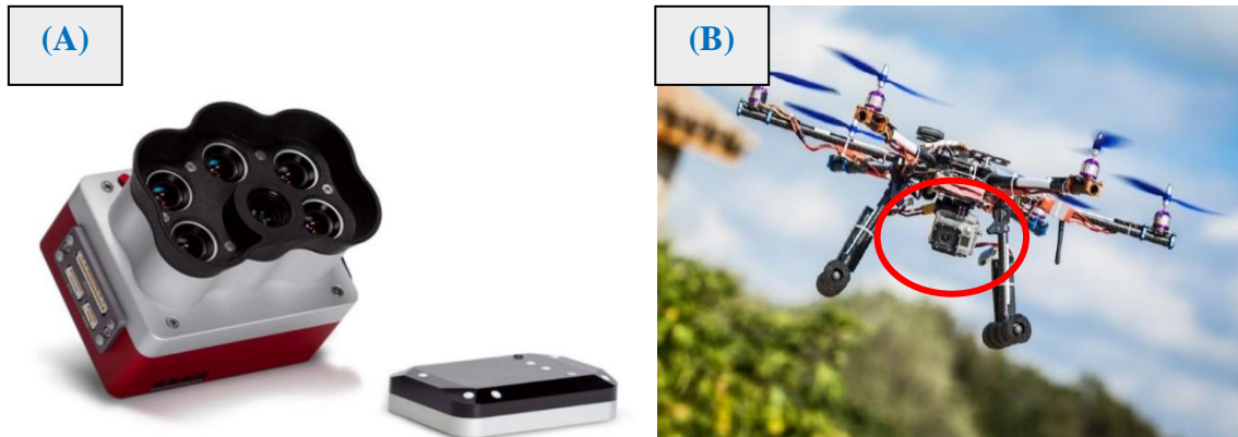
Figura 17. Cámaras multiespectrales: (A) Cámara multiespectral RedEdge-P de cinco bandas espectrales. (B) Cámara multiespectral colocada en un dron. Fuente: (A) https://grupoacre.es/ . (B) Javier Tardáguila Laso. (2021). Tecnologías, Sensores y Plataformas . Universidad de La Rioja.
