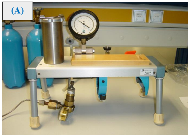
Figura 12. Medición del \Psi : (A) Cámara de presión en laboratorio de la Universidad de La Rioja. (B) Cámara de Schölander portátil que necesita de una bomba externa de aire comprimido para su funcionamiento. Fuente: (A) Rafael Tomás Las Heras. (2019). Práctica 6. Determinación del estado hídrico de la vid. Universidad de La Rioja. (B) https://coltein.com/ .
