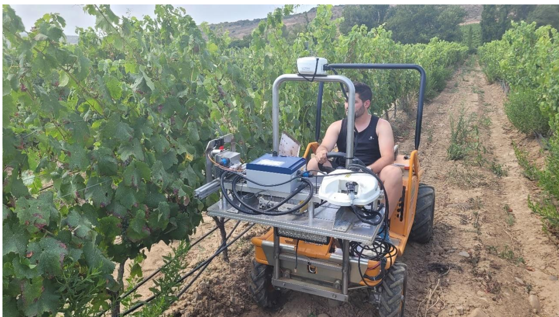
Figura 25. Medición en continuo realizada por un integrante del grupo Televitis de la fila intermedia correspondiente a la réplica de tratamiento T0 del bloque 1 situado en el viñedo experimental (I).
