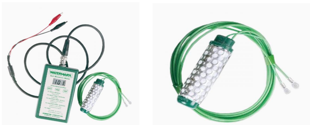
Figura 9. Equipo Watermark para medir el potencial hídrico del suelo mediante resistencia eléctrica. Fuente: https://www.parsros.net/urun/watermark-dijital-toprak-nem-sensoru-ve-dijital-metre/ .
