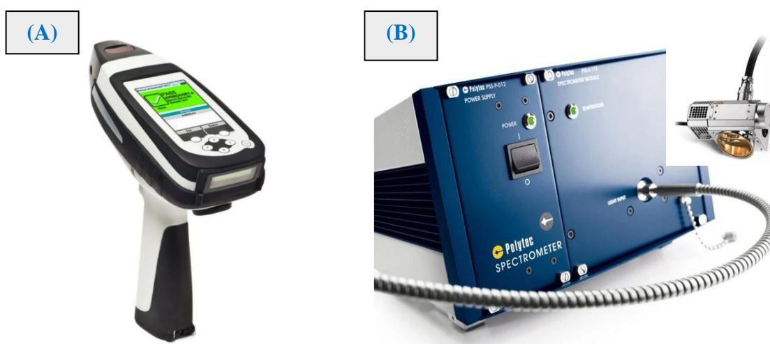
Figura 16. Espectroscopía del infrarrojo cercano (NIR): (A) Equipo de espectroscopía portátil de contacto microPHAZIR RXAnalyzer (1600-2400 nm). (B) Equipo de espectroscopía a distancia Polytec NIR PSS para mediciones en continuo. Fuente: (A) www.thermofisher.com/ . (B) www.redsilverttech.com/ .
