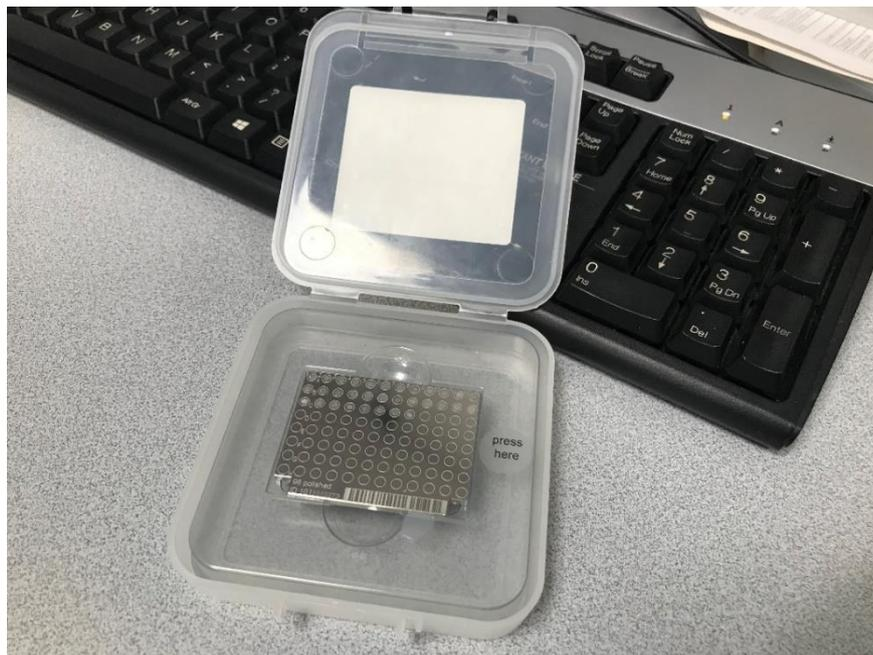
**Figura 6.-** Placa metálica para equipo MALDI Biotyper.
