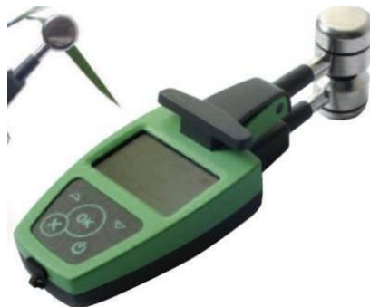
Figura 13. Medidor óptico Dualex. Medidor de pinza portátil que permite medir los índices de clorofila y otros parámetros de las hojas. Se pueden registrar más de 10.000 mediciones, permite exportar datos y georreferenciar las muestras. Fuente: www.gabsystem.com
