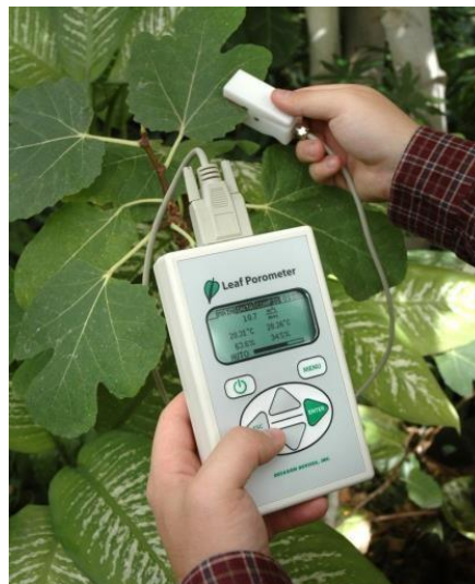
Figura 6. Porómetro tomando medida de la conductancia estomática, detalle de colocación de la pinza del porómetro a la hoja. Fuente www.lapacacr.com
