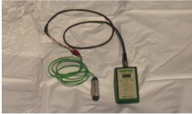
Figura 4. Imagen de un equipo para medir el potencial hídrico del suelo mediante resistencia eléctrica del tipo Watermark, en el que los dos electrodos van encajados dentro de una matriz granular. Fuente: INTA EEASE (2011).
