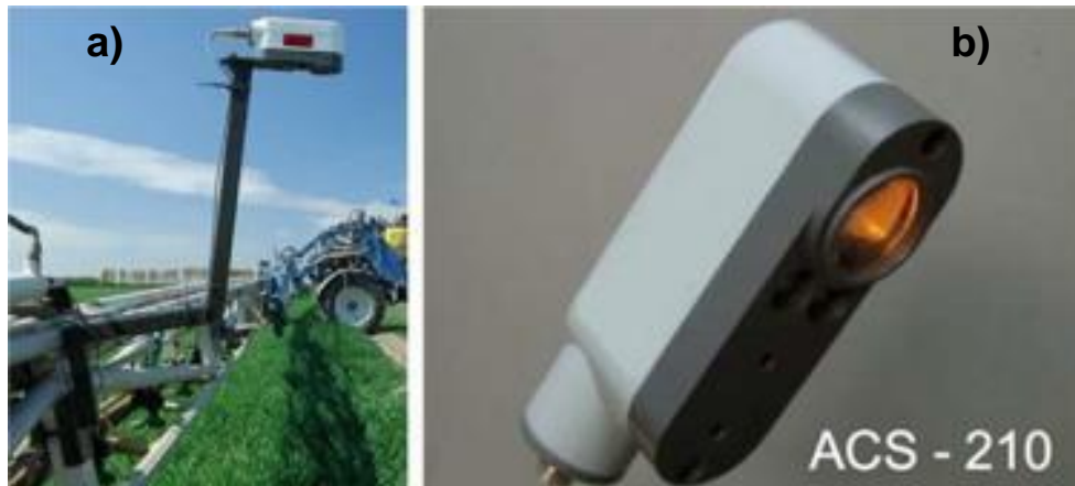
Figura 18. (a) Montaje de sensores CropCircle en maquinaria. (b) Detalle del sensor, el cual es ubicado en forma perpendicular al cultivo. Fuente: Schepers.
